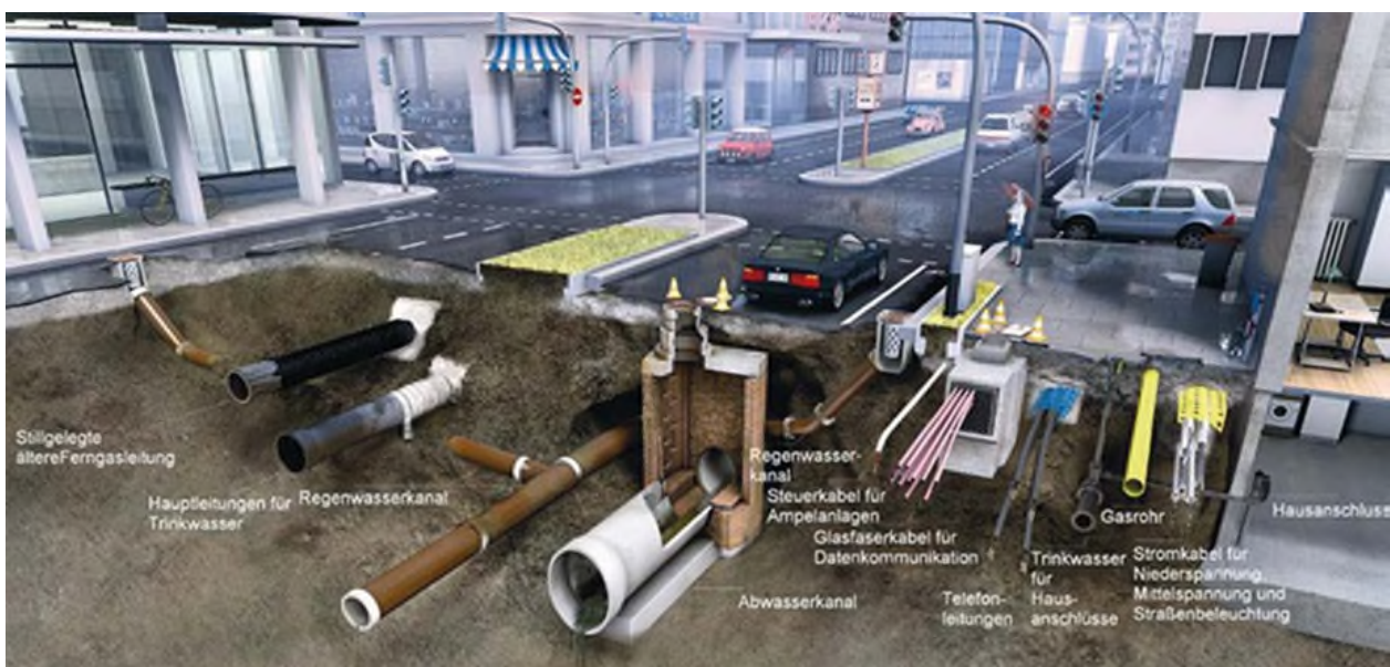
Bild 1 Versorgungsleitungen in der Straße (Quelle: E.ON)
